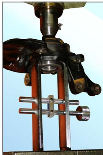
ハブベアリングの押し抜き中
