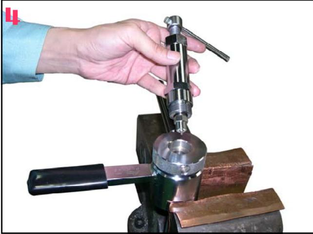
(4) 2番ポンチを、ピストンに最後までネジ込み（左ネジ）ます。さらに、シリンダーアッセンブリーを本体に最後までネジ込み（右ネジ）ます。
