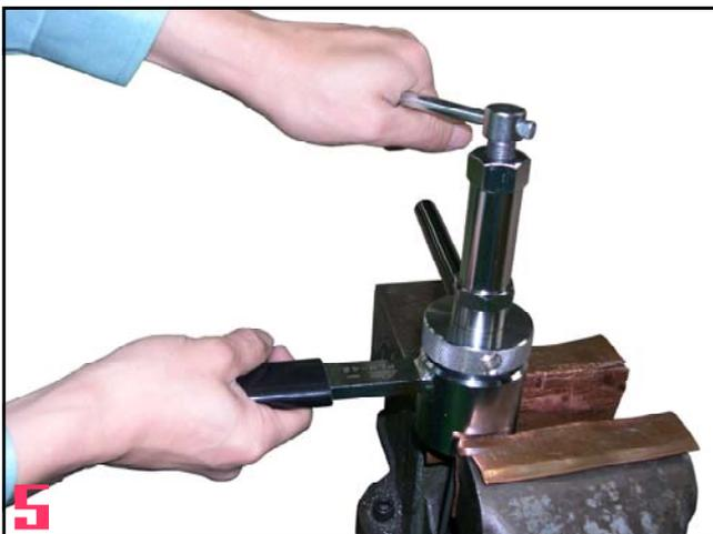
(5) プレッシャーボルトを締め込み、フレア加工を行います。コンベックスフレアは、この2番ポンチだけで完了です。ダブルフレアは、次に3番、4番の順でポンチを差し替えフレア加工が完了します。
