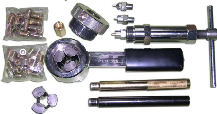
ブレーキパイプの、端面フレアー加工が、純正同様正確に出来ます。
