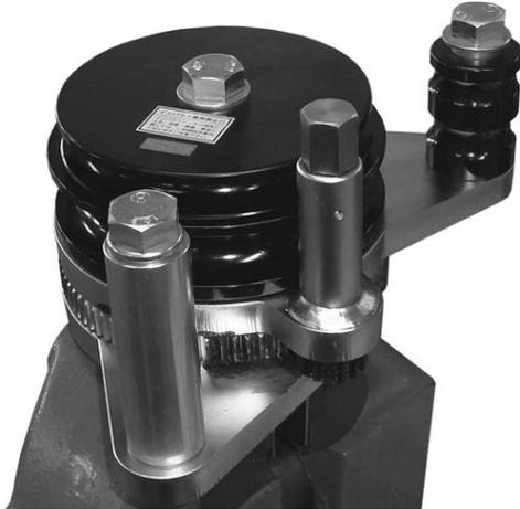
● 手でサイドガード用パイプ、幌骨、ハシゴ、キャリアなどに使われている厚肉の鉄、ステンレス、アルミ、銅パイプを軽々と迅速、正確、簡単に曲げる事ができます!!
