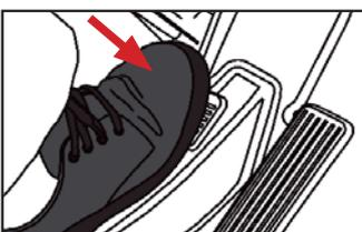
各ホイールシリンダーのエア抜き完了後、ブレーキペダルを数回踏みこんで踏み代が出れば
