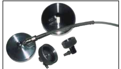
接続キャップ：専用ネジキャップ式。 ※国産 4 メーカーの主要車種 (4t 車～大型) が対象です。2t 車、特殊車及びクラッチのリザーバーには使用できません。 ※クラッチリリース逆送用、ブリーダープラグジョイント (OM-180-61) も別売にて用意しております。
