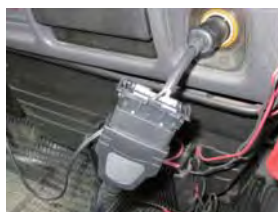
付属品シガー変換コネクター 使用接続例
