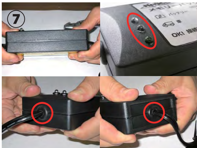
⑦本体ケースを閉める。この時にケース表面にある LED ランプと 左右の配線グロメット（上記の赤色丸印）が ケースの溝にしっかり入っている事を確認してください。
