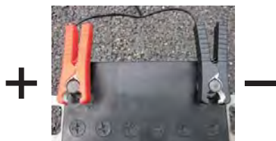
12V 車電源供給バッテリー接続例
