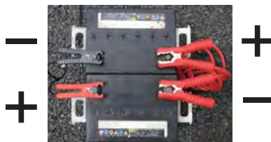
24V 車電源供給バッテリー接続例
