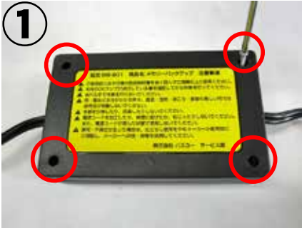
①本体を裏返し、上記の丸印（赤色）4カ所のネジをプラスドライバーで取り外す。
