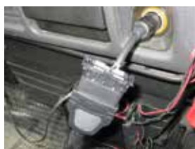
付属品シガー変換コネクタ 使用接続例
