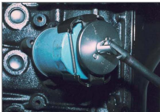
ご注意：増し締め時は、メーカー指定値を厳守してください。締め込み不足はオイル漏れ、締め過ぎてもオイル漏れおよびカートリッジ損傷の原因となります。
