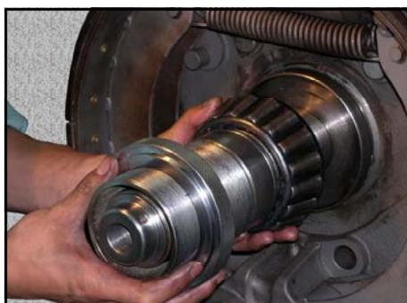
3, アダプターに合う方の、当て金を選定して取り付けます。内径φ75とφ95は、アダプターを使用せず直接ベアリングに当てます。
