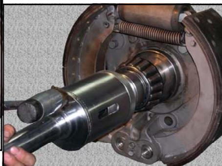
7, 初期締め込み時は、ベアリングが垂直に入っているか確認しながら慎重に作業してください。斜めになっている時は、プラスチックハンマーで、本体上面を叩き修正してください。
