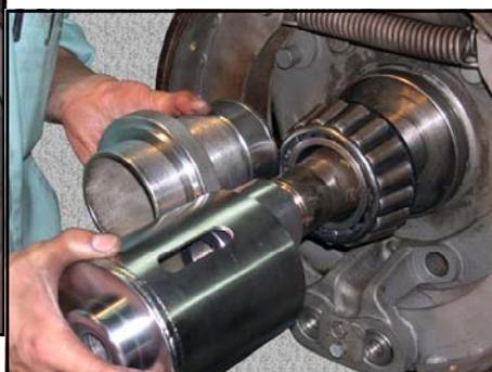
4, 本体をかぶせて、センターボルトがアタッチメントにネジ込まれた状態を推定し、当て金の丸ナット位置を調整します。ベアリングの装着ストロークも勘案してください。
