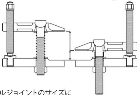
ボールジョイントのサイズに合わせて、支点を調節できますので上下のプレートは平行状態で作業に入れます。したがって、不安定な状態を避け、確実な作業が可能です。
