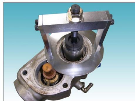
3, ハンガー、ステーをセットし、カラーを入れナットを締め込みます。台座がサーモスタット(スペーサー)上に乗っていないことを確認して下さい。
