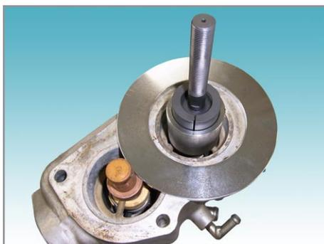
2, センターボルト(グリス塗布)もアタッチメントの内面ミゾ部に合わせてセットし、カバーを内径の大きい方から被せます。
