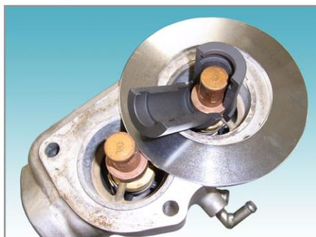
1, ケース取付け面保護のため台座を敷きます。アタッチメントをサーモスタット頭部に被せます。
