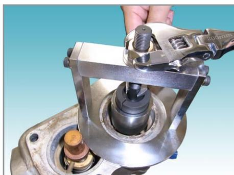
4, センターボルトをスパナで保持(供回り防止)して、ナットを締め付ければ抜き取り出来ます。
