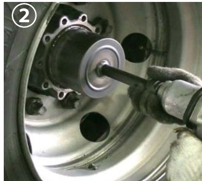
② 車両のホーシングナットに合うサイズを選び必ず低圧のインパクトレンチにて緩めます。
