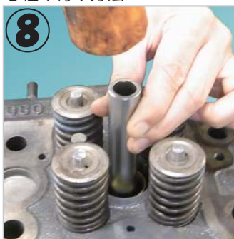
⑧新しいノズルチューブとOリングを組み込みます。ポンチガイトを当て金にして、プラスチックハンマーで定位まで打ち込みます。
