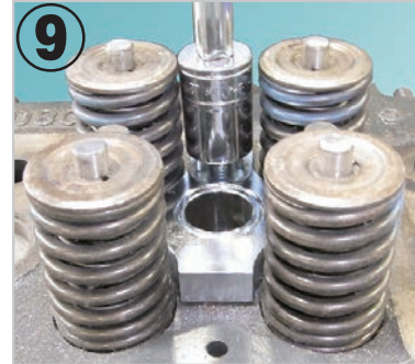
⑨シリンダーヘッドの既存のネジ穴に、付属の六角ボルトでフランジを固定します。
