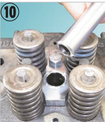
⑩ポンチガイドを入れます。 ※必ず、面取り側をノズルチューブ内にいれてください、間違えると、ノズルチューブ内部が変形します。
