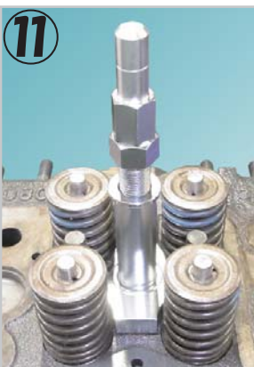
⑪ポンチ A (目印ミツ1本) に、巻き上げナット M15 をいっぱいまでネジ込んでおき、座金 M15 を通します。ポンチのカシメ部周囲に薄くオイルを塗りポンチガイド内に挿入します。※巻き上げナットや座金を入れ忘れると、ピストンを損傷したり、ポンチが抜き取れなくなりますのでご注意ください。
