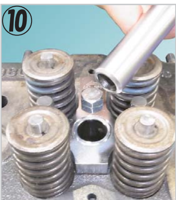
⑩ポンチガイトを入れます。 ※必ず、面取り側をノズルチューブ内にいれてください、間違えると、ノズルチューブ内部が変形します。
