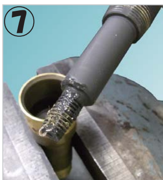
⑦取り外したノズルチューブ ※アタッチメント装着時に少量のグリスを塗布しておくこと作業時に出る切粉を燃焼室への落下防止になります。
