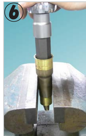
⑥取り外したノズルチューブをバイスで固定してアタッチメントをゆるめて取り外します。
