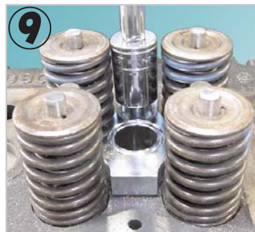
⑨シリンダーヘッドの既存のネジ穴に、付属の六角ボルトでフランジを固定します。
