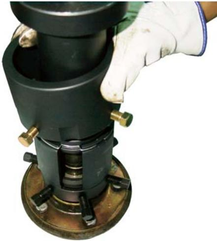
③本体 ASSY 爪部を、引き出しカラーのツバに引っ掛け、爪用カバーをかぶせます。この時、爪用カバーのボルトが、爪の中心部を押せる位置に合わせてください。(図 5)
