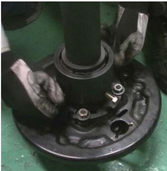
⑧本体 ASSY 爪部を、付属の汎用フランジ (HRBP-869S-14) にのツバに引っ掛け、爪カバーをかぶせます。この時、爪用カバーのボルトが、爪の中心部を押せる位置に合わせてください。
