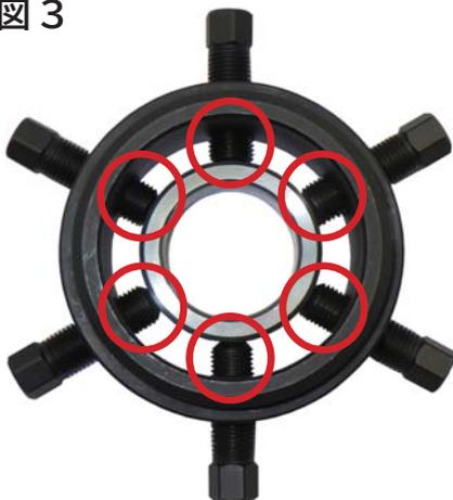
図 3 付属引き出しカラーと付属引き出しカラーボルトで軽自動車のリテーナーをセットした画像です。リテーナーが小径の為、引き出しカラーから引き出しカラーボルトが出過ぎの為、プレス作業時の圧力に耐えられずに引き出しカラーボルトが破損します。この様な場合は、オプション部品型式：HRBP-869S-17 品名：引き出しカラー（小）をご使用ください。
