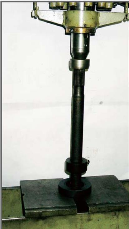
④油圧プレスの当て座に、エンドキャップをかけて、リアシャフトにゆっくりと圧力をかけて押し抜きます。リテーナーは固い物で 12t ~ 15t の圧力が掛かる場合があります。(図 6)
