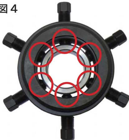
図 4 オプション部品型式：HRBP-869S-17 品名：引き出しカラー（小）と付属引き出しカラーボルトで軽自動車のリテーナーをセットした画像です。図 3 と比較して引き出しカラーから引き出しカラーボルトの突き出し量が少ない為、プレス作業時に引き出しカラーボルトが破損しにくい状態です。
