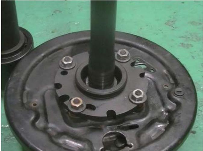
⑦リアブレーキバックプレート部のボルトに付属の汎用フランジ (HRBP-869S-14) をセットしお手持ちの座金と M10xP1.25 のナットを各 4 ケで締め付けて固定します。
