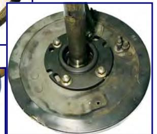
ベアリングがケース入りタイプの場合、汎用フランジを実車のナットで固定します。
