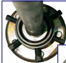
リテーナーの抜き取り時、特殊先端形状の、引き出しカラーボルト6本を、ガッチリ締め付けてリテーナーに食いつかせます。
