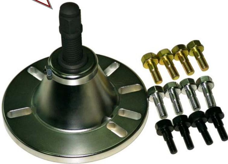
大型トラック、バスのフロントハブが抜き取りできます。ステップ付きホイール、すき間がなくて爪タイプのプーラーが使用できないホイール、傷つけないアルミホイールなどに最適です。
