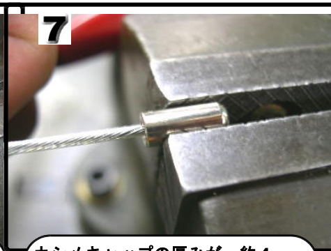
7 カシメキャップの厚みが、約4mmになるまでツブして下さい。
