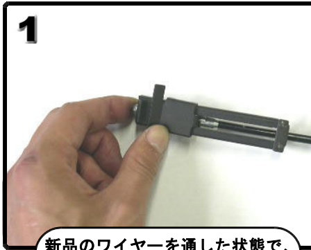
1 新品のワイヤーを通した状態で、爪部を指で縮める。
