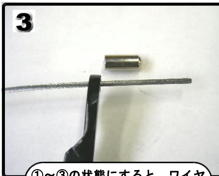
①～③の状態にすると、ワイヤーのカット寸法がわかります。
