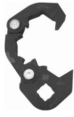
バタフライレンチを開き、 ナットまたはボルトを 包み込むように閉じて、 3/4"(19sq) ドライブの ラチェットレンチや スピンナーハンドルを 差し込んで使用して ください。
