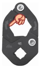
本ツールは、左記写真の矢印方向への 回転にのみ使用できます。回転方向に よっては反転させて使用してくださ い。逆回転をさせると、ナットまたは ボルトの六角部をなめてしまいますの で、十分にご確認の上ご使用ください。
