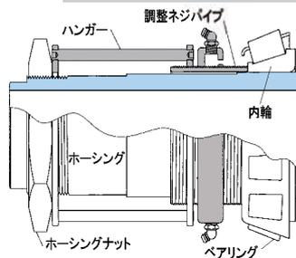
(1) ベアリングの内輪に調整ネジパイプ先端をあて、現車のホーシングナットでハンガーを固定します。ホーシング長に合わない時は、ハンガー部を回転させ調整してください。
