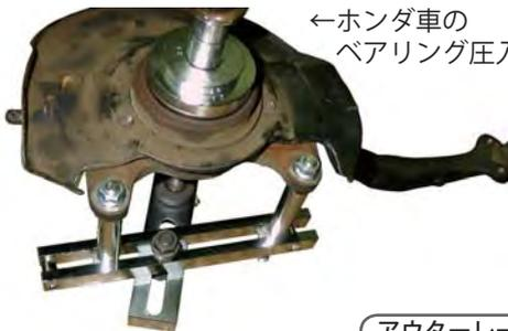
FF車は、一度セッティングすれば、ハブの抜き取りからベアリングの圧入までそのまま作業可能です!!
