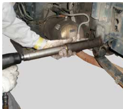
シャックルピン (いすゞ 4t 車) 抜き取り中
