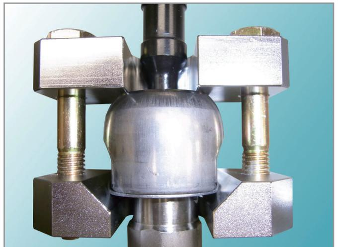
写真のように、プレートAのテーパ面が、ロックワッシャー両端に均等に当たるよう、位置決めをしてください。
