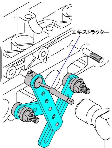
● 正確な下穴加工がされているから、エキストラクターも安心して使用できる！
