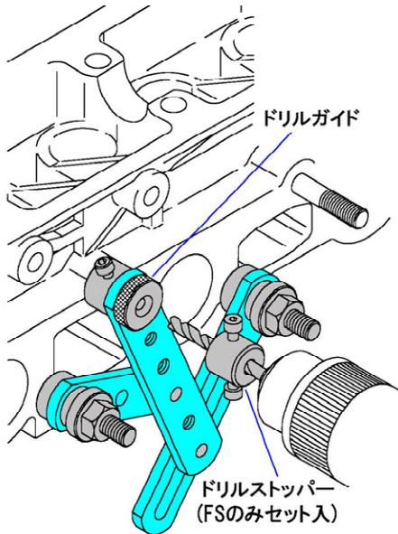
● シリンダーヘッド側に反転させて、既存のナットで本体を固定。後は、ドリルガイドによって確実な穴開け作業が可能です！
