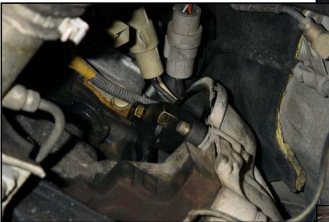
1G-FEエンジンの場合は、スペーサーおよびギアアタッチメントを、[RB-1]の位置で使用します。(1G-Gエンジンと異なります。) また、フライホイールのギアが減っていたり、型式・年式などでも、取り付け位置の変更が必要なことがあります。
