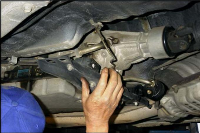
スターターモーター取り外しの際、上側の取り付けボルトが、スペース的に外せないものがあります。その場合は、左写真のように、ミッションの固定ボルトを外し、位置を少し下げてください。
