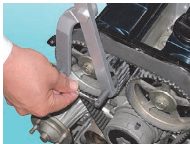
左右の固定ピンを回し、固定ピンのツバ部が カムプーリーの裏側に引っ掛かる様に調整する。 （固い時は、スパナを使用）
