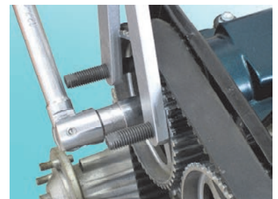
カムプーリーと工具本体がガタが 無いことを確認してから センターボルトをゆるめます。
