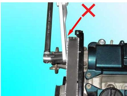
⚠ 左記の様にカムプーリーと工具本体が離れている状態で作業を行うと部品及び工具の破損の恐れがありますので、必ず右記の様にカムプーリーと工具本体がしっかりとガタが無いことを確認してからセンターボルトをゆるめる作業を行ってください。
