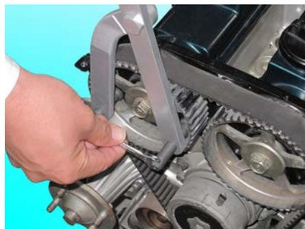
左右の固定ピンを回し、固定ピンのツバ部分がカムプーリーの裏側に引っ掛かる様に調整する。（固い時はスパナを使用）
