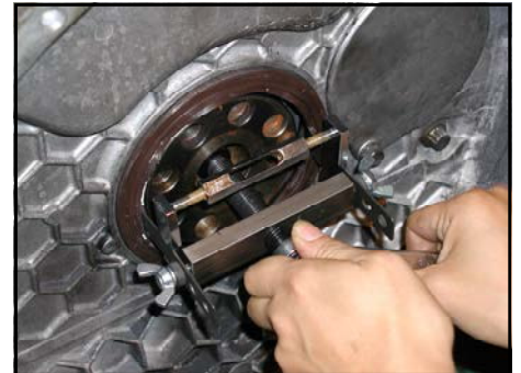
オイルシールの抜き取り中
