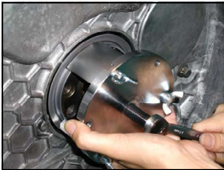
スリンガーの抜き取り中
