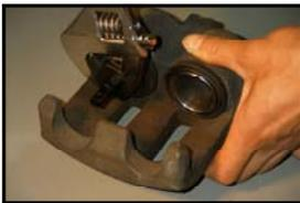
(4) プライヤー ASSY の爪を、センターシャフトの穴に通し、片方をキャリパーに掛け、ピストンを抜きます。
