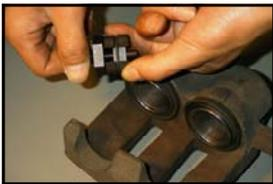
(2) ピストン内へできるだけ奥まで挿入して、受け金部を保持しながらセンターシャフトを締め付け、内径にフィットさせます。締め過ぎに注意してください。
