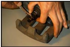
(3) モンキーなどで受け金部をつかみ、左右に軽く振り固着を外します。センターシャフトの穴が、正面を向く位置で止めておきます。
