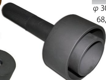
油圧プレスの治具としても使用できる、充分な強度です。ベアリング内径に合うプレートがあれば、左記写真のようにガイドとして2枚取り付けて使用できます。
