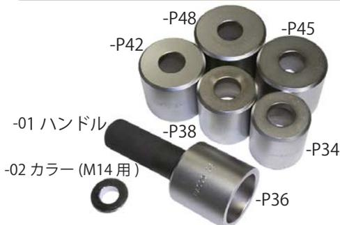
※ボールジョイントを、垂直にしてから作業に入ってください。斜めに打ち込むとブーツを傷めますのでご注意ください。
