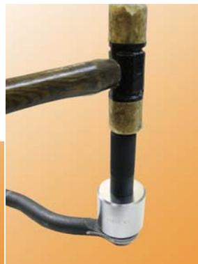
タイロッドエンドブーツ(圧入タイプ)の装着が、簡単確実に行えます。
