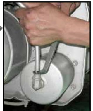
チューブに合うサイズの固定板を選び、押し板をコネクタに当てて、反対側の固定板でコネクタのリテーナー（コレット）部が強く押せる様に工具をあわせてから強く握ったまま、反対側の手でチューブを引き抜きます。
