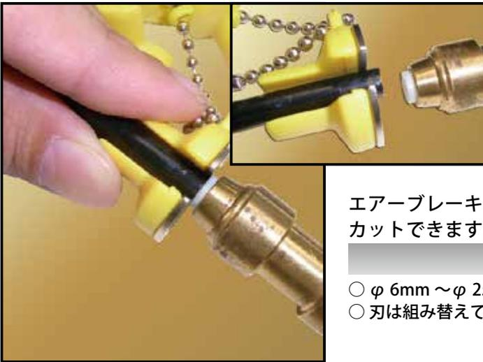
親指と人差し指でツールを持ち、チューブに上から被せるようにセット。コネクターのリテーナー(コレット)部を強く押しつけながら、他の指またはもう一方の手で、チューブを引き抜きます。
