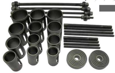
ブッシュ、ベアリングなどのサイズに合わせて、右写真のように台座とアタッチメントを組み合わせて使用してください。油圧プレス作業の受け台にも最適です。 ※ センターボルトは、作業可能な限り太く短いものを使用してください。細く長いボルトは、大変曲がりやすいため慎重に作業を行ってください。
