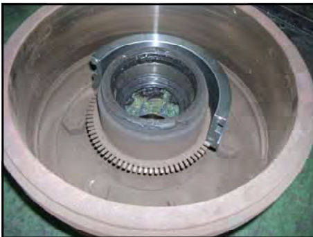
抜き取り用アタッチメントをセット。
