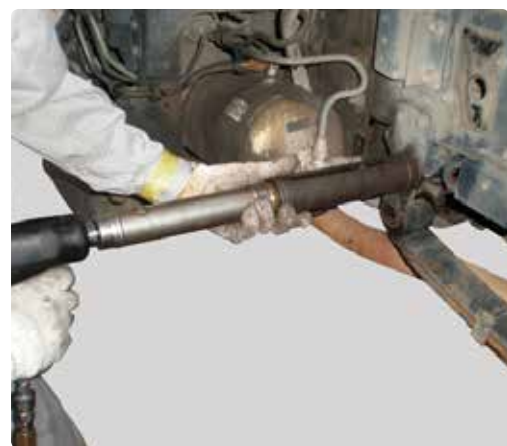
シャックルピン (いすゞ 4t車) 抜き取り中
