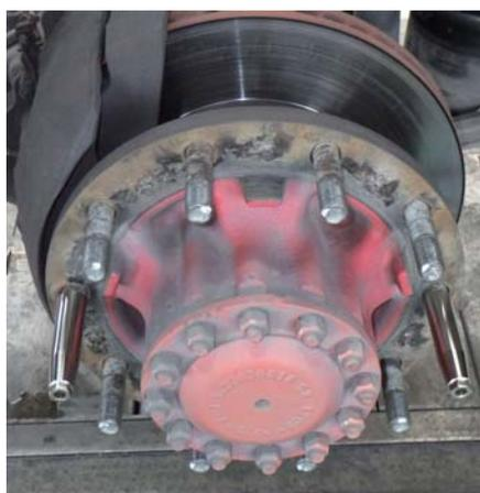
① 本製品をハブボルトに対して対角線上に確実にセットしてください。
