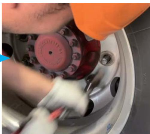
③ 本製品が手で引き抜けなかった場合は、本製品の先端部の二面幅にお手持ちのプライヤー等を使用して本製品を引き抜いてください。
