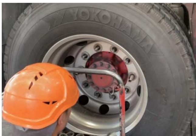
② ホイールを取り付け、本製品をセットして無いハブボルトにホイールナットを手で締め込んでから本製品を手で引き抜いてください。
