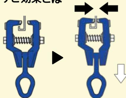
図のようにフックを引くことにより、本体がハの字に閉じて先端部に強烈な噛み込み力が発生します。
