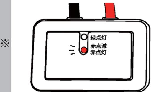
※溶接時に、溶接ノイズの吸収を検知した場合
