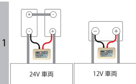
①本工具を車両と繋がっている端子に接続して下さい。
