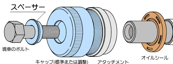
装着は現車のボルトを使用するネジ込み式、さらにセンター出しスペーサーにより、簡単で確実な作業が可能です。
