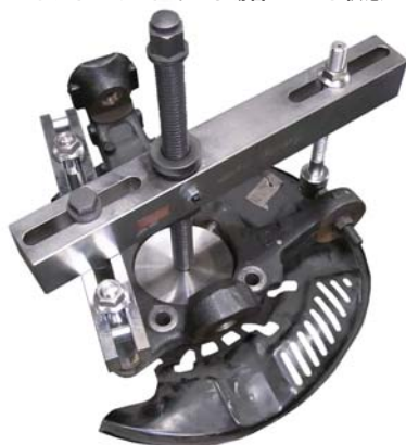
ボルト止めされている場合のセット状態
