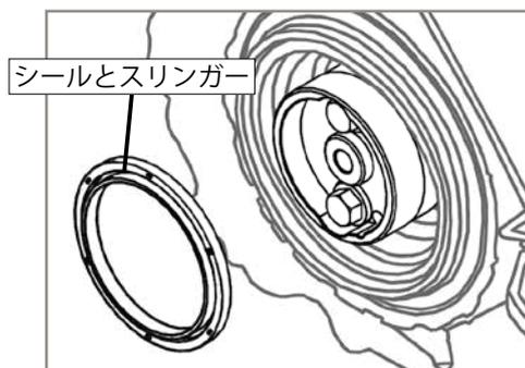
4 ②ガイドアタッチメントに新品のフロントクランクシールとスリンガーをセットします。
