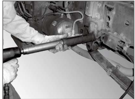
シャックルピン(いすゞ4トン車)抜き取り中
