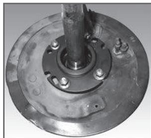
ベアリングがケース入りタイプの場合、汎用フランジを実車のナットで固定します。
