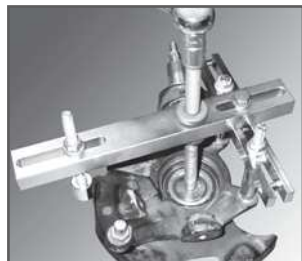
日産車のハブ抜き取り中
