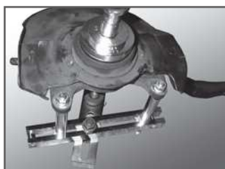
ホンダ車のベアリング圧入中
