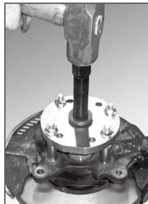
ハイエース 200系 ベアリングケース抜き取り中
