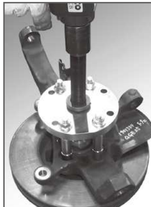
キャラバン ベアリングケース抜き取り中
